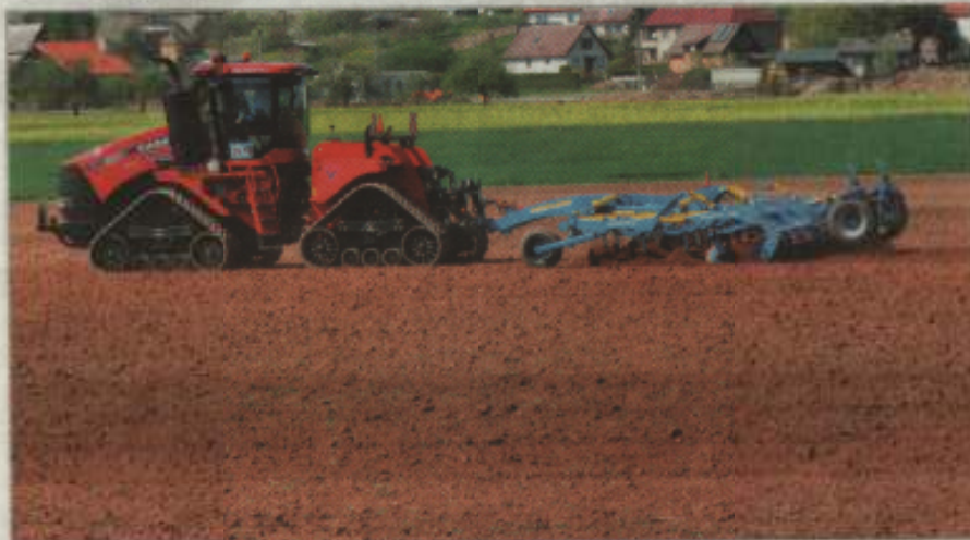
Obr. 4 – V systémech s řízenými přejezdy se s výhodou uplatňují pásové traktory
