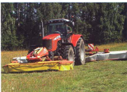
Obr. 1: Pracovní souprava - Massey Ferguson 7490 Dyna VT s rotačním žacím strojem PÖTTINGER NOVACAT 306 F alfa-motion (čelně nesený) a KUHN GMD 8730 (vzadu nesený)
