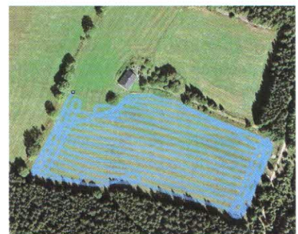
Obr. 4: Pozemek č. II.C s trajektorií jízdy při sečení rotačním žacím strojem PÖTTINGER NOVACAT 306 F alfa-motion (čelně nesený) a KUHN GMD 8730 (vzadu nesený)
