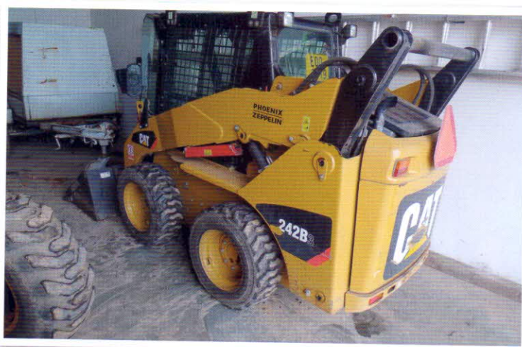
Manipulace se surovinami – smykem řízený kolový nakladač CATERPILLAR 242B3 (53 kW) s objemem lopaty 0,43 m 3 a 3179 kg
