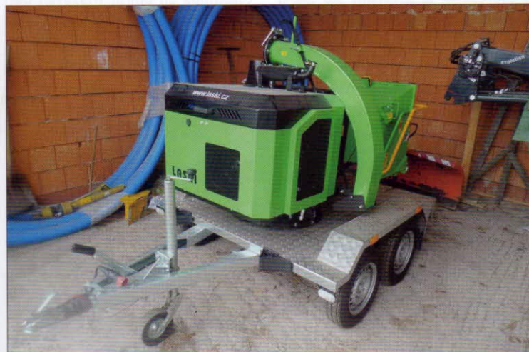
Jemná dezintegrace - štěpkovač dřevní hmoty LASKI LS150D je poháněn dieselovým motorem Lombardini (21 kW). Maximální průměr dřevní hmoty 150 mm, výkon se pohybuje mezi 7 až 12 m 3 /h
