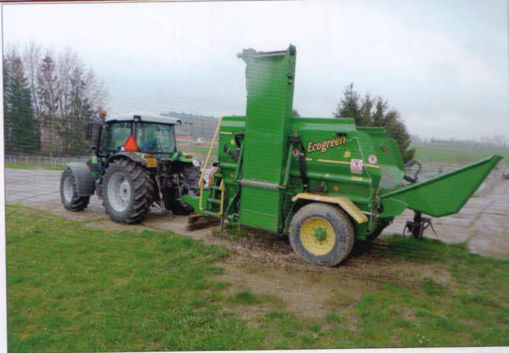
Promíchávání a homogenizace surovin – drtič biomasy ECOGREEN – Zago 15SD GRU s objemem násypky 2,0 m 3
