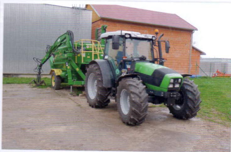
Energetický prostředek – kolový traktor DEUTZ-FAHR AGROFARM 430 (79,6 kW)
