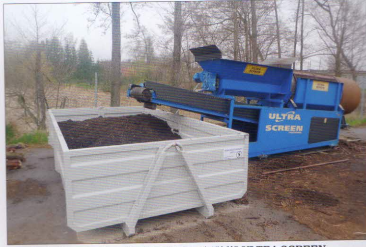
Prosévání kompostu – bubnový síťový třídič ULTRA SCREEN Trommel s elektromotorem 7 kW. Třídící výkon dosahuje 15–30 m 3 /h podle vlastností surovin, velikost oka síta 20 x 20 mm
