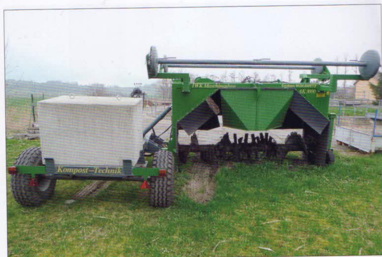
Překopávání kompostu – tažený překopávač kompostu MORAVETZ AK 3000 s pracovním prostorem 3 x 0,8 m je vybaven adaptérem pro manipulaci s kompostovací plachtou
