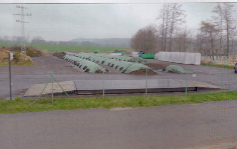
Evidence přijímaných surovin - silniční nájezdová váha Josef Rotter Sezemice Standart SU ocelové konstrukce s váživostí do 30 000 kg (přesnost ±10 kg)
