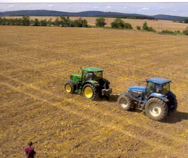
Obr. 6 – Měření tahové síly pneumatik Mitas PneuTrac
