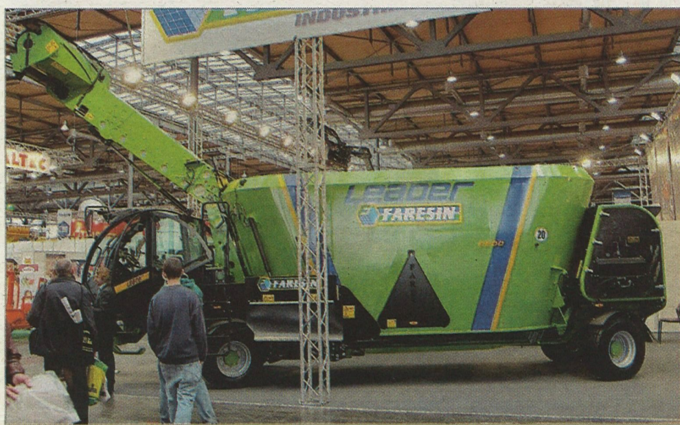
Obr. 10 – Dvě říditelné nápravy zlepšují manévrovatelnost. Naproti tomu umístění motoru v zadní části MKV prodlužuje jeho délku a manévrovatelnost zhoršuje. Je proto potřebné velice pečlivě prověřit průjezdné profily stáji a manévrovací prostor kolem stáji a skladů krmiva (poloměry zatáčení, sklon rampy v silážním žlabu ve vztahu ke světélce výšce MKV apod.)
