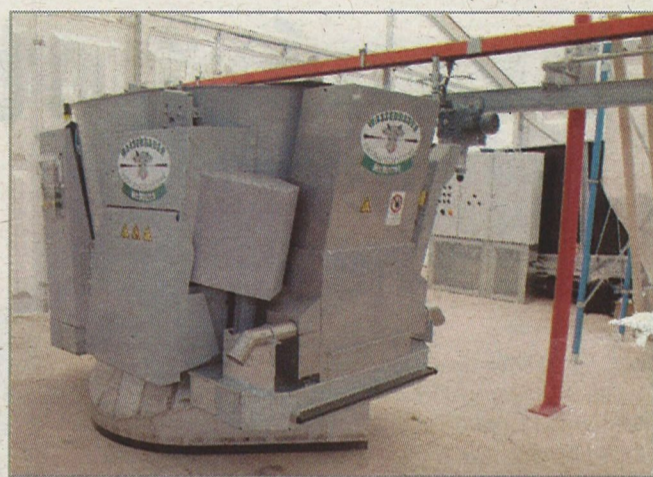
Obr. 19 – Poloautomatický systém rakouské firmy Wasserbauer Mixmeister 3000 má vlastní podvozek a jeho pohyb je řízen vodící kolejničí. Dávkuje krmivo do žlabu a současně přihřívá zbytky krmiva. Je také vybaven dávkovačem krmných a minerálních směsí, které může zakládat na zbytky krmiva ve žlabu, čímž zlepší jejich vyžírání Foto Jiří Vegrícht
