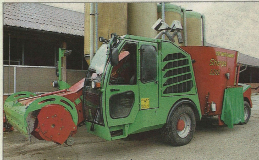
Obr. 3 - Na výstavě EuroTier 2012 představila firma Strautmann samojízdný MKV Sherpa 1201 s nově řešeným oddělováním a nakládáním krmiva. Oddělování krmiva zajišťuje odřezávací štít s aktivními noži a nakládání odděleného krmiva na dopravník provádí rotační válec s obvodovou šnekovicí. Tak je zajištěno energeticky úsporné a šetrné oddělování krmiva. Hodnotící komise udělila tomuto exponátu stříbrnou medaili Foto archiv firmy
