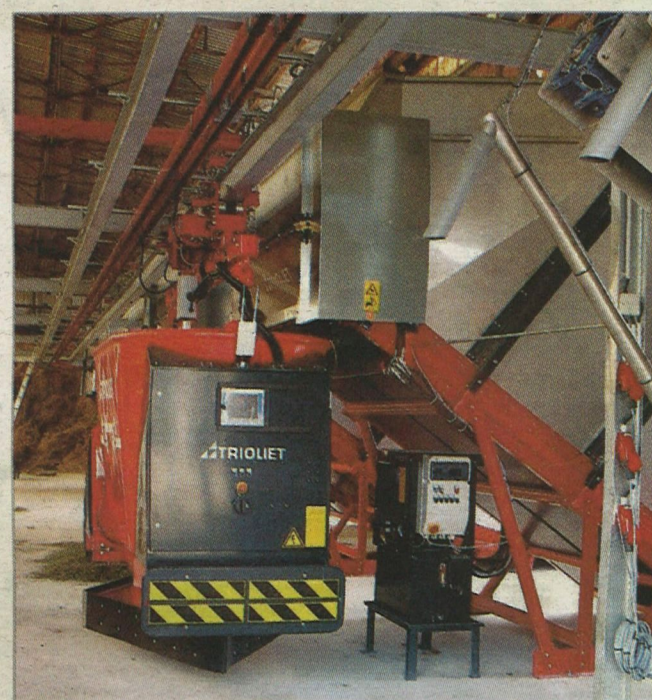
Obr. 14 – První robotizovaný systém krmení firmy TRIOMATIC, varianta T30, je instalován na farmě v Záluží u Sušice. V meziskladu je instalována soustava paralelně uspořádaných dávkovacích zásobníků pro objemové krmivo a zásobníků s dávkovačem pro krmné směsi a další komponenty krmné dávky. Řízení přípravy krmné dávky a její plnění do krmného vozíku řídí počítač
