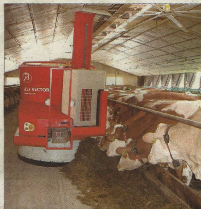
Obr. 13 – Robotizovaný systém krmení – Lely Vector provozovaný na farmě Dubových, krmivo ve stáji zakládá a přihrnuje nebo jen přihrnuje v závislosti na množství zbytků krmiva ve žlabu (laserové čidlo snímá výšku vrstvy krmiva ve žlabu)
