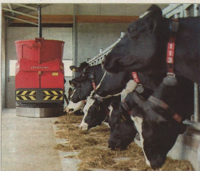
Obr. 15 – Nejnovější robotizovaný systém krmení TRIOMATIC T15 má vlastní podvozek, je napájen a řízen subtilní vodící drážkou, která nezatěžuje konstrukci stáje Foto Jiří Vegrícht
