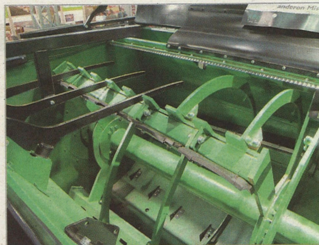
Obr. 8 – MKV s míchacím hřídelem (pádlem) se vyznačují šetrným zacházením s krmivem. Jsou často vybaveny zařízením umožňujícím zpracování obřích balíků a přidavnými noži pro lepší dělení krmiva s dlouhou řezankou Foto Jiří Vegrícht
