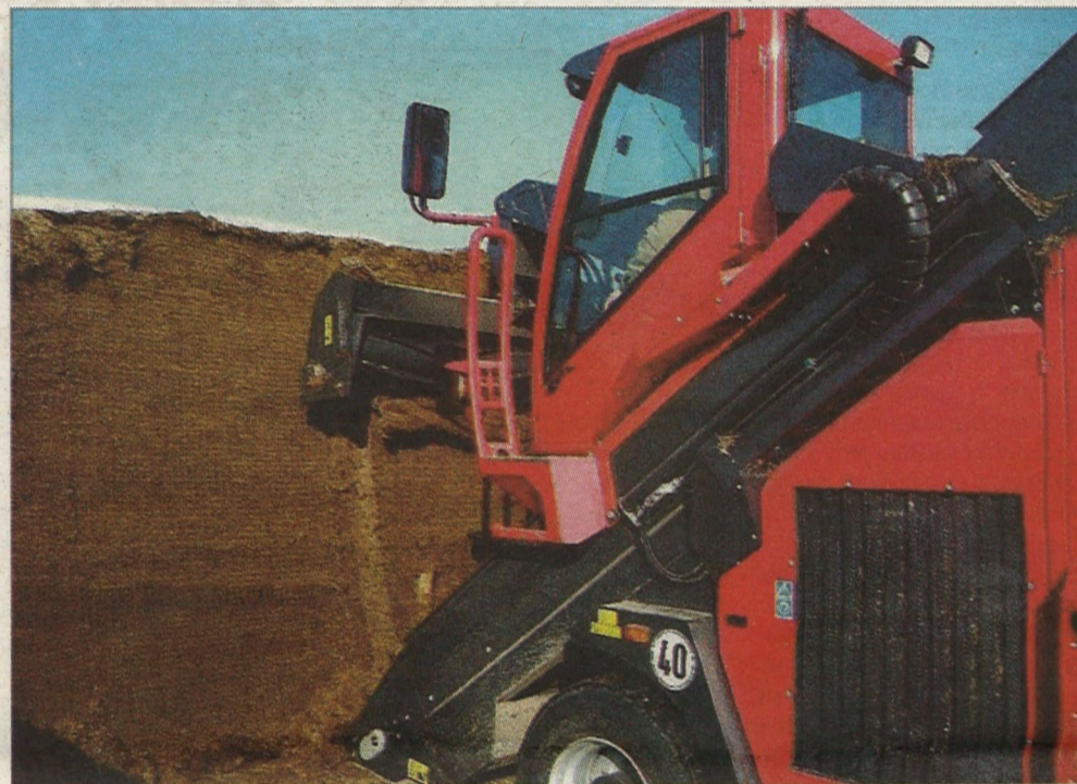
Obr. 5 - Již delší dobu nabízí firma Trioliet u svých samojízdných MKV oddělování krmiva zařízením s aktivními noži, mj. oceněné na výstavě EuroTier stříbrnou medailí, které se vyznačuje velmi šetrným zacházením s krmivem a příznivou měrnou spotřebou energie na oddělování krmiva Foto Jiří Vegrich
