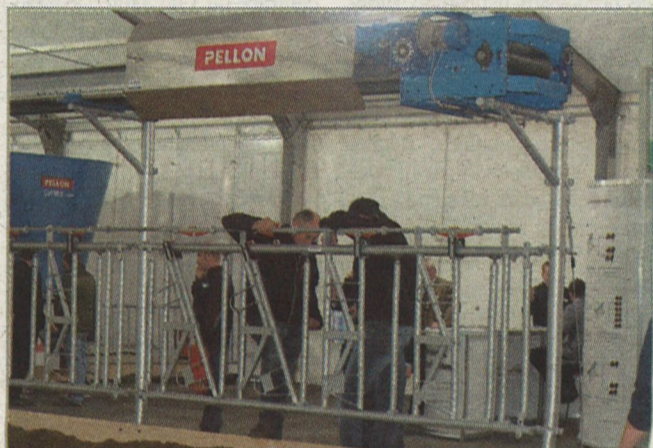
Obr. 20 – Robotizovaný systém krmení firmy PELLON využívá pro zakládání krmiva do žlabu nadžlabový dopravník se shazovacím vozíkem. Krmná dávka je připravována v přípravě krmiva zařízením pro přípravu TMR, tvořeným nejčastěji stacionárním MKV, do kterého jsou postupně dávkovány jednotlivé komponenty, následně zamíchány a vyskladňovány na spojovací dopravníky a nadžlabový dopravník Foto Lukáš Rytina
