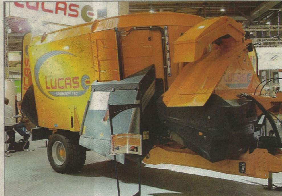
Obr. 6 - Firma Lucas vyrábí zajímavě řešený MKV s vertikálními šneky s možností kombinování funkce krmení (vynášecí dopravník) a podestýlání (metač) Foto Jiří Vegrich
