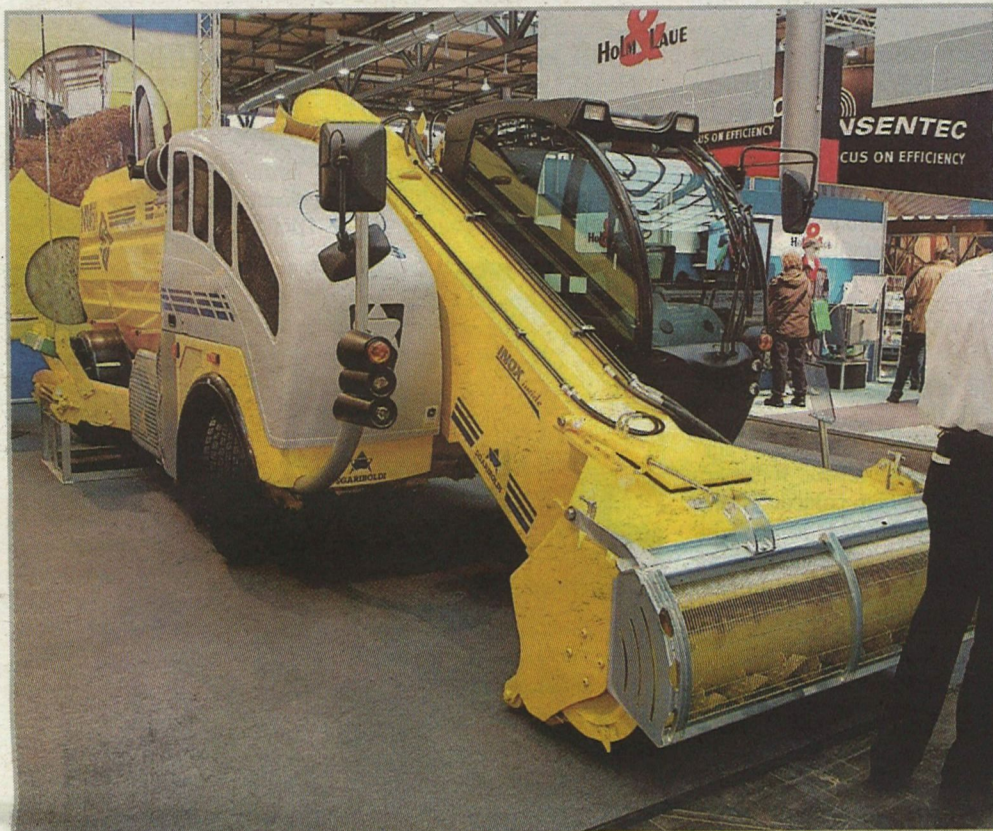
Obr. 7 – Samojízdné míchací krmné vozy mají mnohdy i libivý design. Umístění motoru v přední části zkracuje celkovou délku MKV a zlepšuje jeho manévrovací schopnosti. Nevýhodou je větší vzdálenost vynášecího dopravníku od místa obsluhy a nutnost sledování procesu zakládání pomocí zpětných zrcátek Foto Jiří Vegrícht
