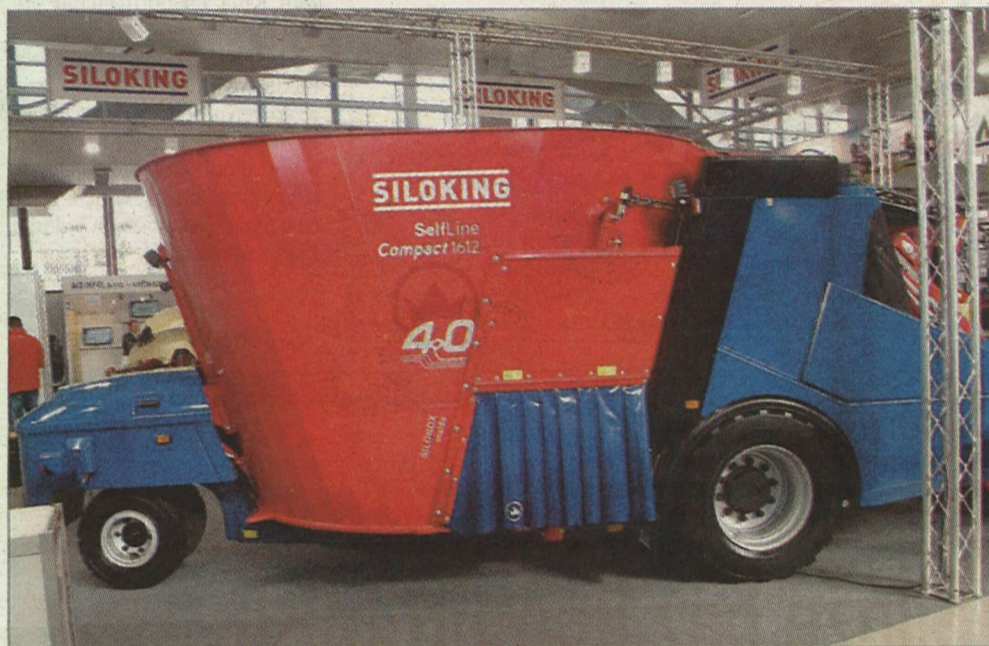
Obr. 2 - U samojízdných MKV je důležitá i dobrá manévrovatelnost a odpovídající zatížení náprav tak, aby byla zajištěna dobrá trakce i ve složitějším terénu. To zajistila firma umístěním motoru vpředu nad přední hnanou nápravou. Tím docílila rozložení hmotnosti 70 % na hnanou nápravu a 30 % na zadní říditelnou nápravu. Podvozek je v podstatě trojkolka s poloměrem otáčení 4,50 až 4,75 m. Na výstavě EuroTier 2014 byla tato koncepce MKV oceněna udělením zlaté medaile Foto Jiří Vegrich
