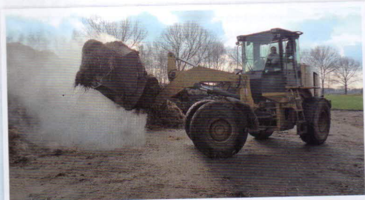
Manipulace se surovinami – čelní kolový nakladač Caterpillar 928H s diesellovým motorem (120 kW) a objemem lopaty 2,3 m 3
