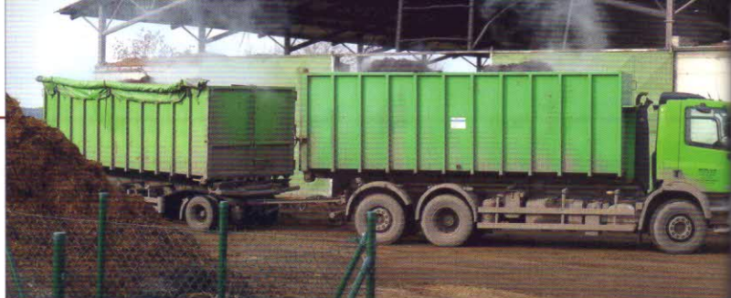
Přeprava surovin a vyrobeného kompostu - svozové vozidlo DAF (320 kW) s přívěsem (objem korby automobilu 30 m 3 , objem korby vleku - 30 m 3 , celkové přepravované množství max. 28–30 t)
