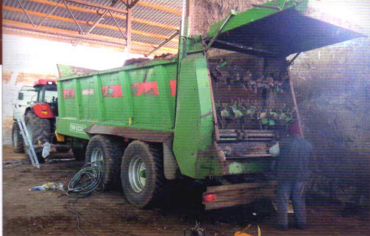
Aplikace kompostu na zemědělskou půdu - rozmetadlo kompostu BERGMANN TSW 6230 S za kolovým traktorem s výkonem minimálně 130 kW. Objem korby rozmetadla je 20 m 3 . Výkonnost dosahuje asi 70 t/h při aplikační vzdálenosti do 1 km
