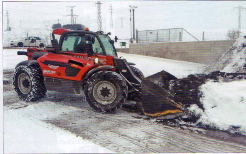
Manipulace se surovinami – manipulátor Manitou 634 s čelní lopatou širokou 2,5 m
