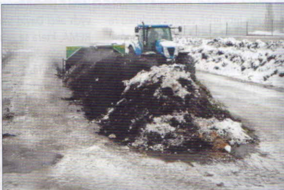
Překopávání kompostu – překopávač kompostu IWK Maschinenbau, GmbH AK 3300 poháněný vývodovým hřídelem traktoru, pracovní prostor má rozměry 3,3 x 1,7 m
