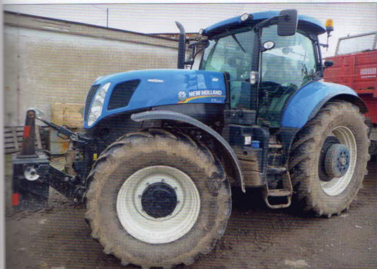
Energetický prostředek – kolový traktor New Holland T7.270 s výkonem motoru 160 kW a předním adaptérem
