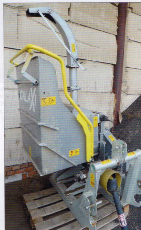
Jemná dezintegrace – štěpkovač GALAXI M150 poháněný traktorem (výkonost 2 m 3 /h)
