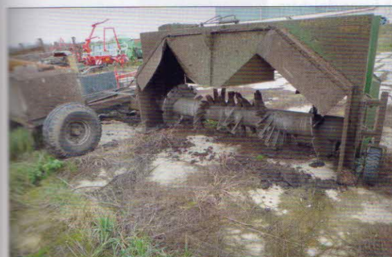
Překopávání kompostu – překopávač kompostu IWK Maschinenbau, GmbH AK 3300 poháněný vývodovým hřídelem traktoru, pracovní prostor má rozměry 3,3 x 1,7 m
