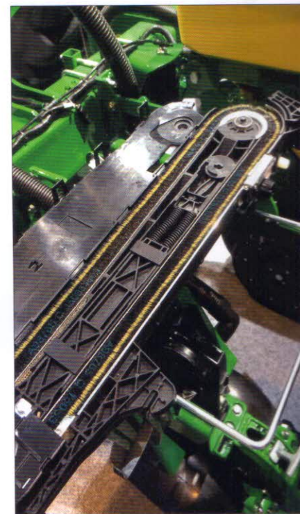
Obr. 7 – Detail konstrukce unášeče, který nahradil krátký semenovod přesného secího stroje
