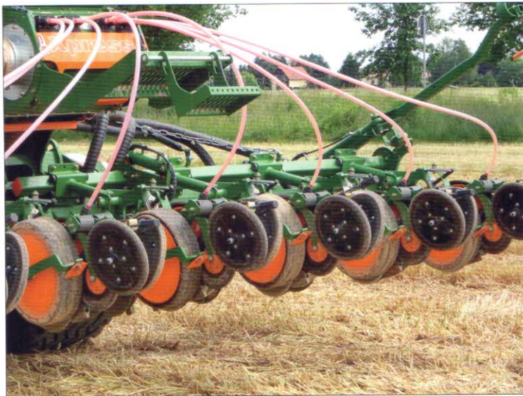
Obr. 5 – Příklad technického řešení stroje na přesné setí s centrální zásobní skříní na osivo a s centrálním dávkovačem s jednozrnkovým náběrem osiva
