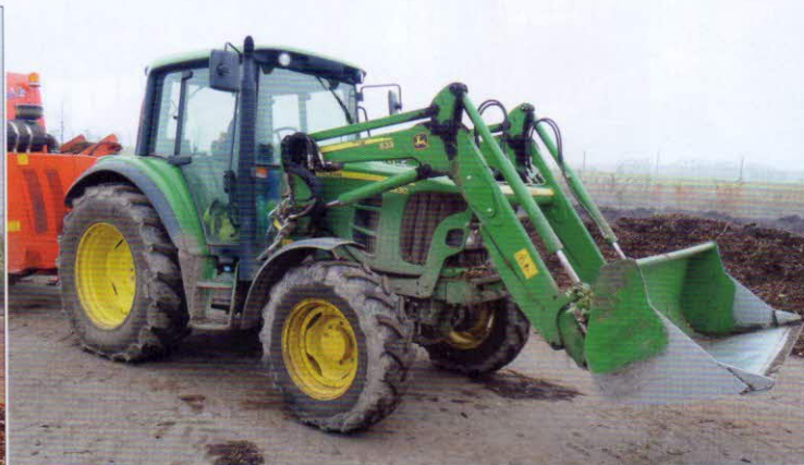
Energetický prostředek, manipulace se surovinami – kolový traktor JOHN DEERE 6230 s dieselovým motorem 74 kW. Traktor je vybaven čelním nakladačem s lopatou o objemu 2,5 m 3
