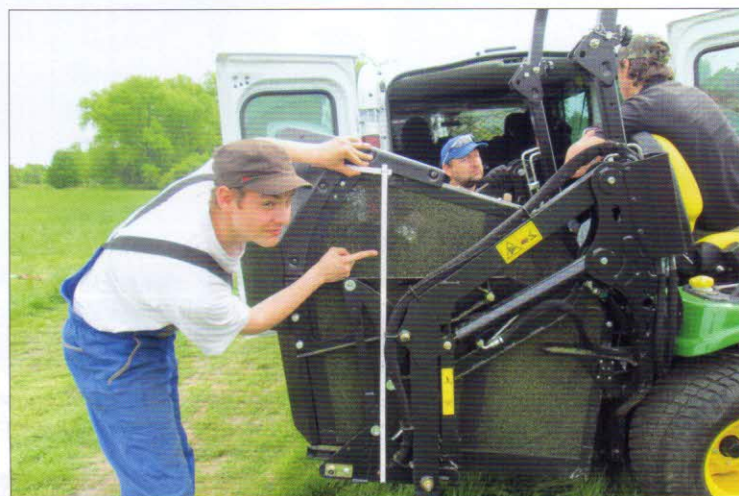
Obr. 6 – Zaplnění sběracího koše do výšky 0,75 m
