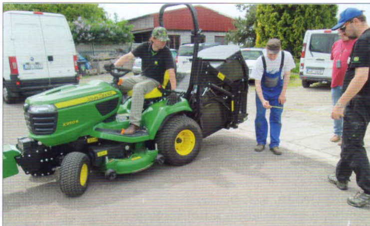
Obr. 1 – Měření poloměru otáčení žacího traktoru JOHN DEERE X950R
