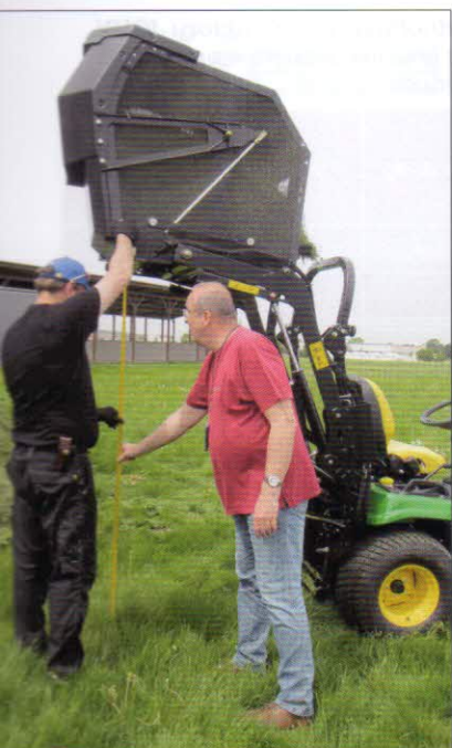
Obr. 4 – Měření výšky vysypání koše u měřeného traktoru JOHN DEERE X950R
