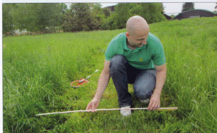
Obr. 3 – Měření šířky sečení
