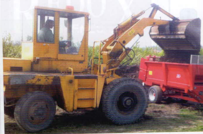
Manipulace se surovinami – čelní kolový nakladač HON UN - 053.1 se vznětovým motorem Zetor (46 kW), lopata má objem 1,4 m 3
