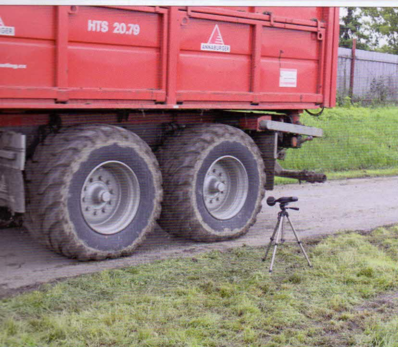
Obr. 4 – Umístění hlukoměru u kraje vozovky, měření hluku projíždějící soupravy
