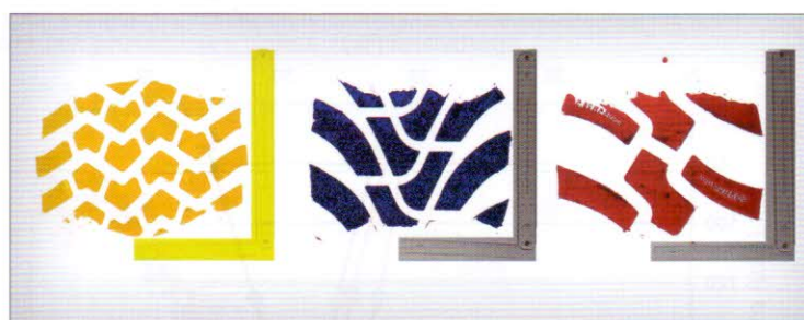
Obr. 6 – Otisky pneumatik vedle sebe – Michelin (žlutá), Mitas (modrá), BKT (červená)
