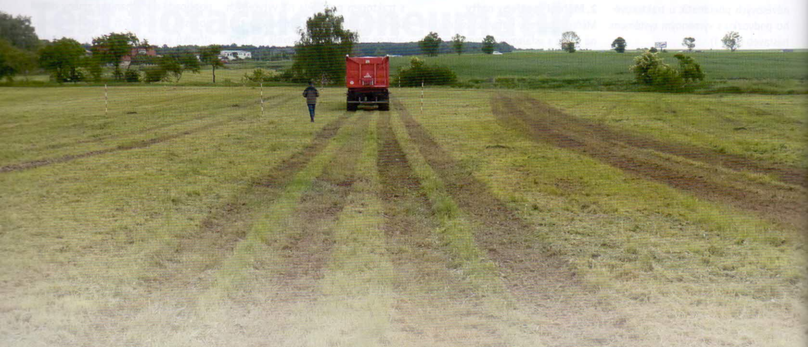
Obr. 3 – Jízda soupravy na vytyčeném úseku „vlastní stopou“. Na obrázku je úsek pro jízdu rychlostí 10 km/h po projetí soupravy s návěšovými pneumatikami Michelin a Mitas
