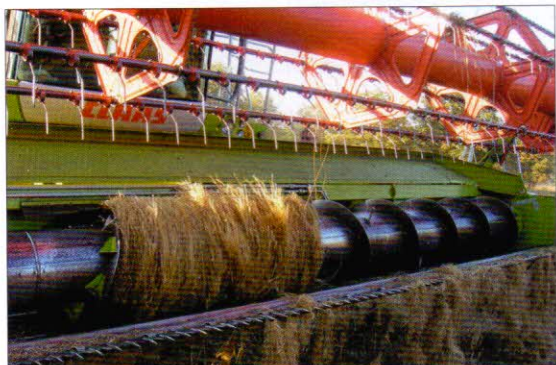
Obr. 5 – Namotávání na průběžný šnekový dopravník a ucpávání kosy nedoříznutými zbytky rostlin
