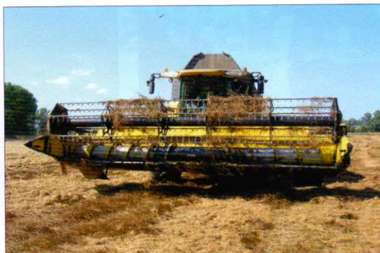
Obr. 6 – Zachytávání rostlin na přiháněči a na žacím válu pod prsty kosy a v oblasti děliče
