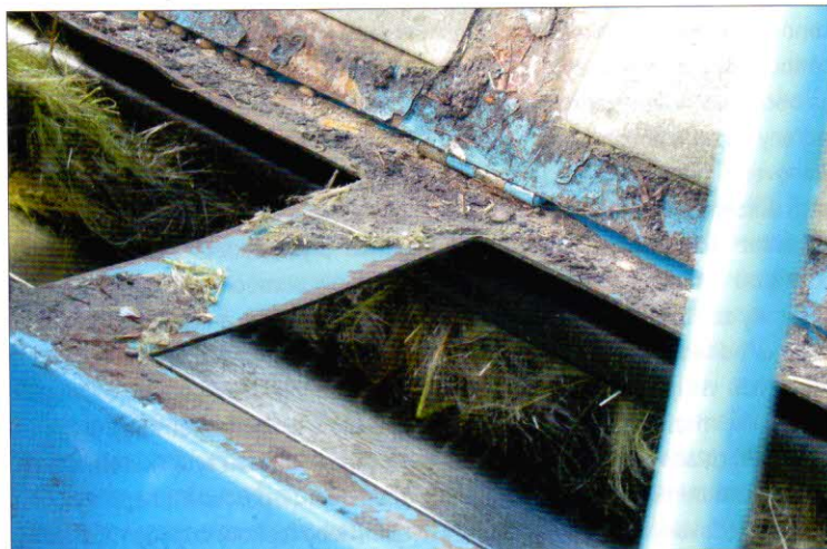
Obr. 7 – Ucpání mláticého ústrojí a namotávání na odmítací buben
