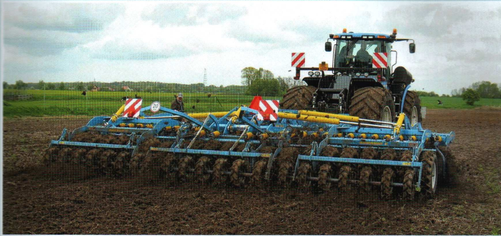
Ke kypřičům i kombinátorům je dodávána široká škála válců, které upravují povrchovou vrstvu půdy Foto Josef Hůla
