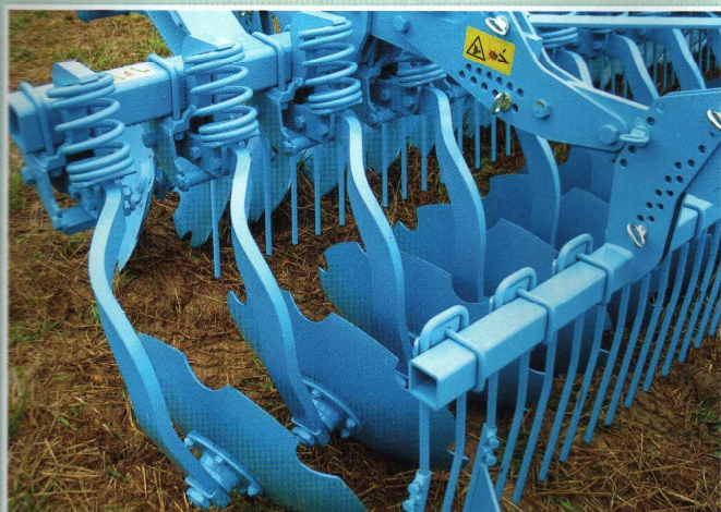
U talířových kypřičů je využíváno i uchycení jednotlivých talířů na samostatných slupicích
