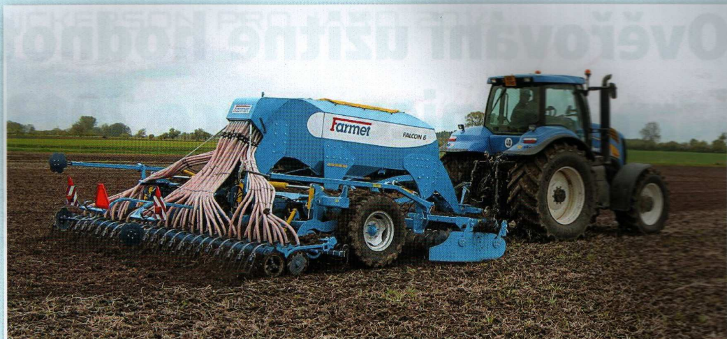
Secí stroj s pneumatickým výsevním ústrojím s centrálním dávkovačem a zásobníkem umožňujícím snadné plnění osivem Foto Josef Hůla
