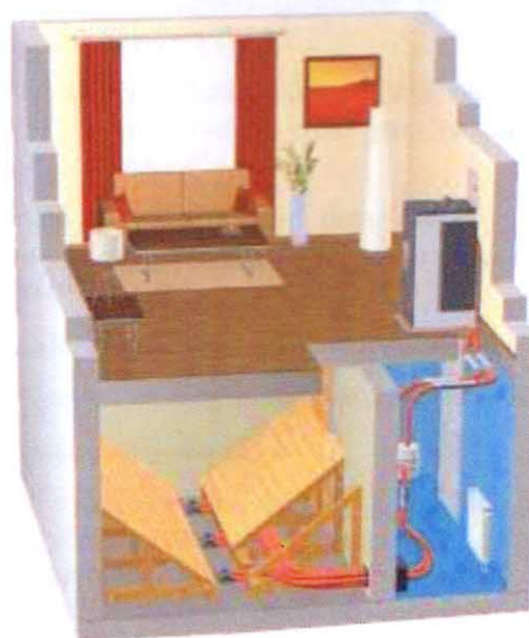
Obr. 20: Zapojení peletových kamen a možnost umístění skladu pelet v rodinném domě
