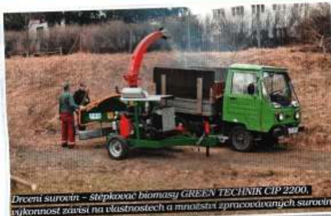
Drcení surovin – štepkač biomasy GREEN TECHNIK CIP 2200, účinnost závisí na vlastnostech a množství zpracovávaných surovin
