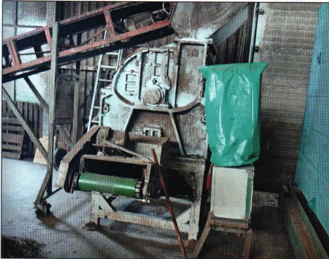
Drcení doprňkových komponent – drtič DAG 100/P s el. motorem 45 kW
