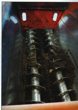
Promíchávání a homogenizace surovin míchacím a vázicím strojem SEKO – Sam 5 – GC ME s elektrickým motorem (37 kW). Pracovní prostor má objem 11 m 3 . Výkonnost se pohybuje okolo 5 m 3 /h. Stroj je vybaven vázicím zařízením SekoTronic 150
