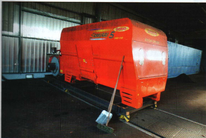
Promíchávání a homogenizace surovin míchacím a vázicím strojem SEKO – Sam 5 – GC ME s elektrickým motorem (37 kW). Pracovní prostor má objem 11 m 3 . Výkonnost se pohybuje okolo 5 m 3 /h. Stroj je vybaven vázicím zařízením SekoTronic 150
