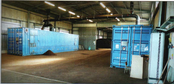
Kompostování probíhá aerobní fermentací v uzavřeném prostoru dvěma fermentory EWA (model 2011). Doba zpracování je 2 až 4 dny
