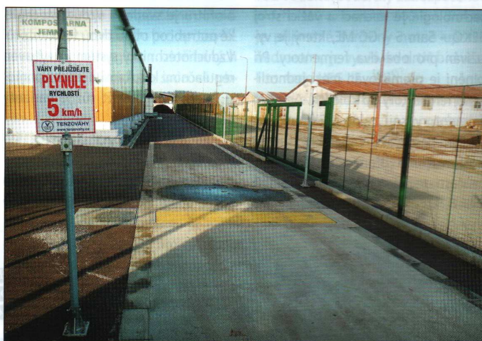
Evidence přijímaných surovin silniční nápravovou váhou VM-1.2 s váživostí do 20 000 kg a přesností ±5 kg
