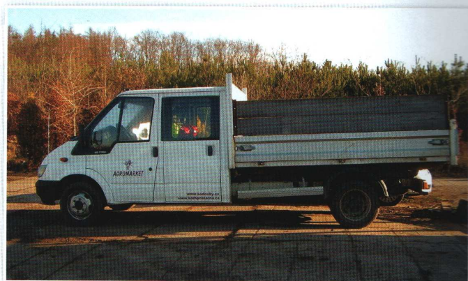
Přeprava surovin a produktů - nákladní automobil FORD TRANSIT 350 L (sklápěč), objem nákladního prostoru 3 m 3
