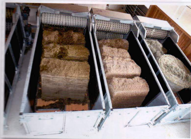
Obr. 9 – Poloautomatický systém rakouské firmy Wasserbauer Mixmeister 3000 využívá v přípravě krmiva několik paralelně uspořádaných dávkovacích zásobníků s vodorovným dnem. To umožňuje ukládat jednotlivé bloky krmiva těsně za sebou a nevzniká tak nebezpečí převrácení nebo rozpadnutí bloku krmiva při frézování a dávkování
