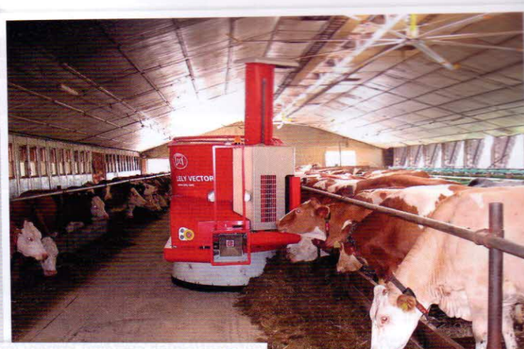
Obr. 4 – První realizace poloautomatického systému krmení firmy Lely Vector je v provozu na farmě v Boubíně. Lely Vector krmivo ve stáji zakládá a přihruje nebo jen přihruje v závislosti na množství zbytků krmiva ve žlabu (laserové čidlo snímá výšku vrstvy krmiva)
