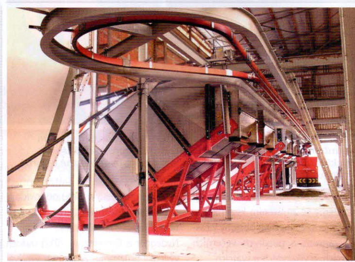
Obr. 6 – První poloautomatický systém firmy Trioliet, varianta T30, je připraven k provozu na farmě pana Kubělký v Záluží u Sušice. V meziskladu je instalována soustava paralelně uspořádaných dávkovacích zásobníků pro objemové krmivo a zásobníků s dávkovačem pro krmné směsi a další komponenty krmné dávky. Řízení přípravy krmné dávky a její plnění do krmného vozíku řídí počítač
