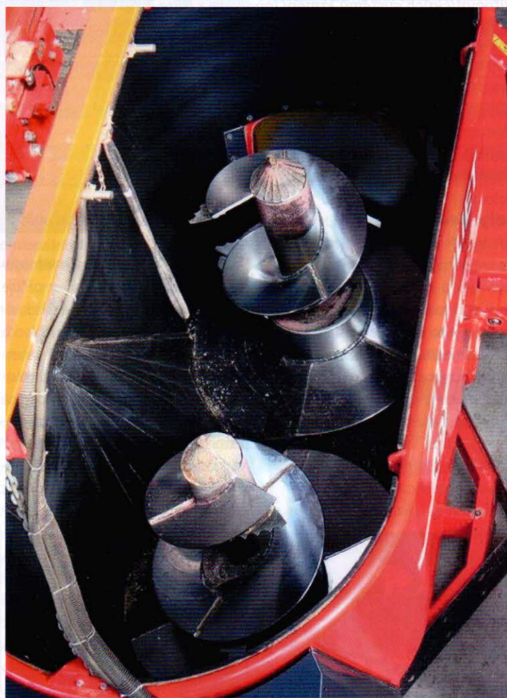
Obr. 5 – Robotizovaný krmný vozík, který je základním prvkem poloautomatických systémů Trioliet, využívá pro míchání a vyskladňování dva vertikální míchací šneky uspořádané v korbě o objemu 3 m 3
