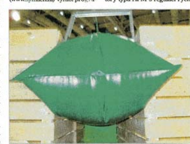
Obr. 5 – Zajímavý systém utěšovacích vaků při provětrávání brambor skladovaných v ohradových paletách vyvinula firma HGV Tolsma GmbH – SRN
