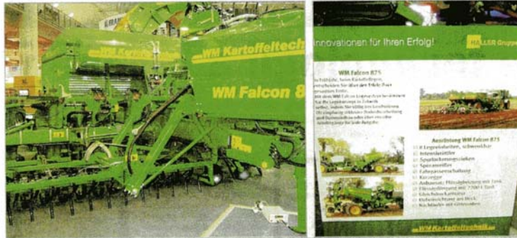
Obr. 4 – Firma WM Kartoffeltechnik (dříve Wühlmaus) představila nový osmířádkový kombinovaný sázeč brambor Falcon 875 s rotačním nářadím na přípravu půdy a formovačem hrubků a nové prosévací prvky dopravních pásů šetrnější k hlízám u sklizeň WM 8500
