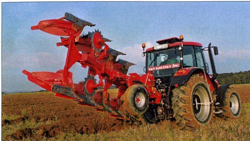
Obr. 6 – Pro Zetor 135 Forterra představoval čtyřradličný pluh pracující ve snadno obdělávatelné půdě jen malou zátěž a jeho motor vytižil jen na 50 až 60 %
