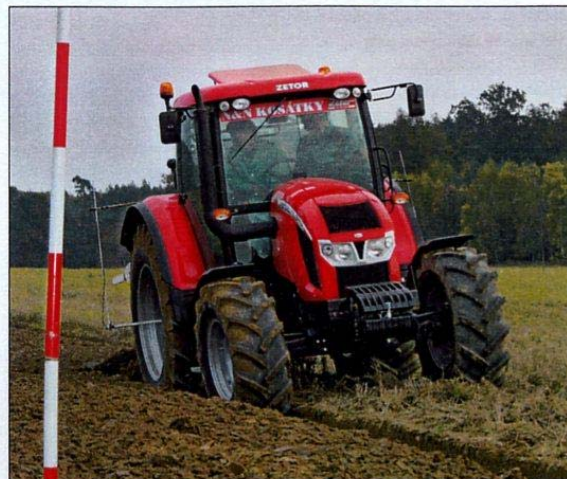
Obr. 1 – Kvalita práce při seřízení pluhu s táhlem o délce 57,5 cm byla na výborné úrovni
