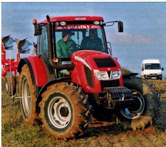
Obr. 7 – Měření orební soupravy při otáčení na souvrati. Na fotografii je vidět snímač otáček na pravém kole zadní nápravy, pomocí jehož údajů byl následně stanovován prokluz (na základě změřeného odvaleného obvodu kol a rychlosti jízdy stanovené pomocí GPS)
